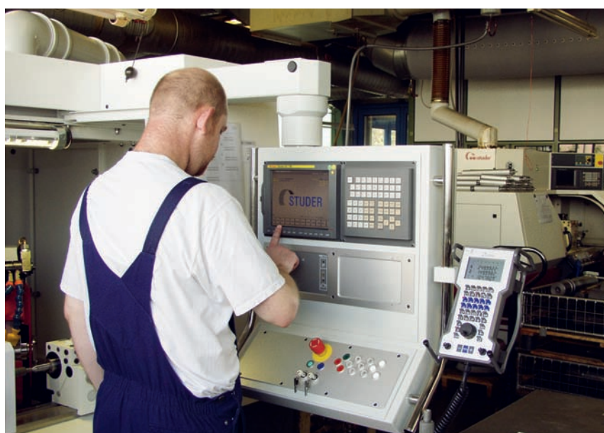
4 Ein großer Vorteil der Studer-Steuerung ist deren Durchgängigkeit: Das zugrundeliegende Konzept wie auch die Bedienoberfläche blieben bei aufeinanderfolgenden Maschinengenerationen stets konstant
